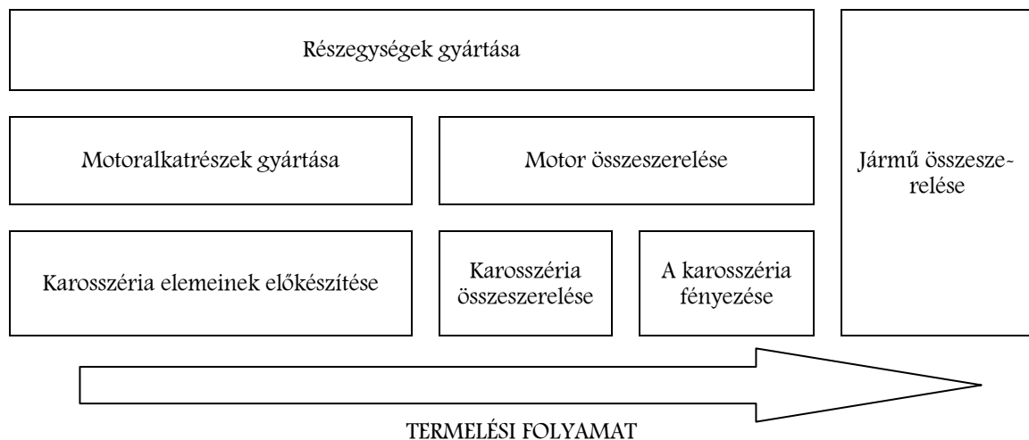
2. ábra Az autógyártás jellemző gyártási fázisai
